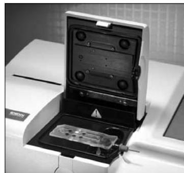
**Figura G-1:** Analizador VetStat con casete de muestra colocado
