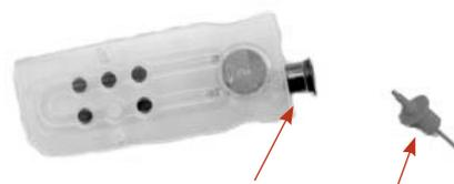
Figura C-2: Orificio de entrada de la muestra y adaptador de la jeringa
