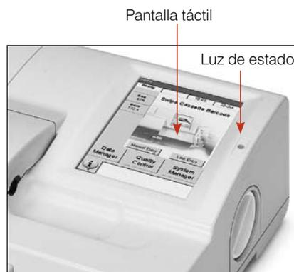
Figura A-2: Pantalla táctil y luz de estado
