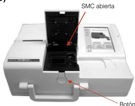
Figura A-3: Cámara de Medición de la Muestra (SMC)
