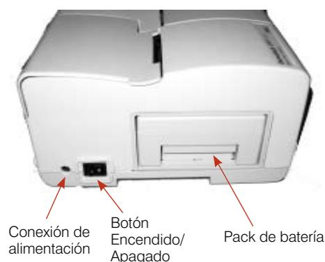
Figura A-7: Izquierda del analizador VetStat
