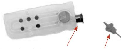
**Figura G-3:** Orificio de entrada de la muestra y adaptador de la jeringa
